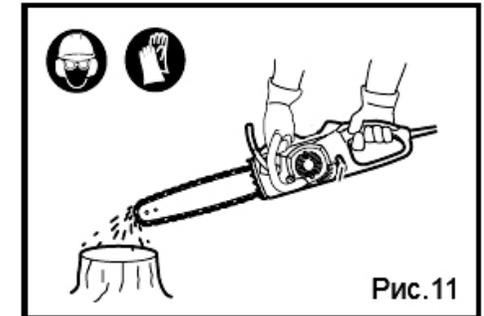
Для проверки подачи масла на цепь разместите пилу на ровной поверхности, укрытой, например, газетой, и включите её. Устойчиво разрастающееся на газете масляное пятно после включения пилы свидетельствует о работоспособности системы смазки пилы. При необходимости отрегулируйте подачу масла с помощью вращения регулировочного винта, расположенного рядом с заливной горловиной.
