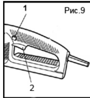
При переводе рычага защиты передней ручки в положение “от себя” произойдет остановка пильной цепи, при этом двигатель пилы продолжит свою работу. Эта функция предназначена для мгновенной остановки цепи для предотвращения аварийных ситуаций и травм.
