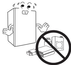
2. Не допускается хранить в помещении, где установлен котёл, химически активные вещества, такие как аммиак, хлор, сера и различные кислоты.
