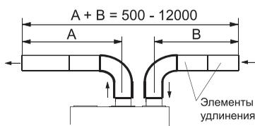
При монтаже раздельной системы дымоудаления, труба отвода дымовых газов всегда присоединяется к центральной патрубку, а труба для забора воздуха присоединяется к правому или левому патрубку, в зависимости от удобства монтажа. Незадействованное воздухозаборное отверстие закрывается специальной заглушкой.
