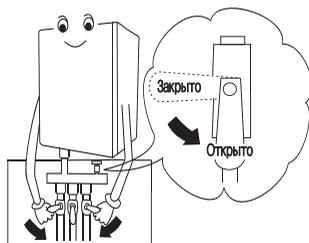
**4. Заполнение котла и системы отопления водой.**
