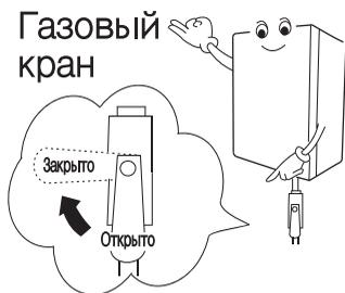
**3. Проверьте положение запорных и распределительных кранов в системе отопления.**
